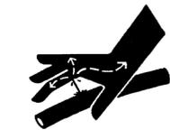
Não verifique vazamentos no circuito hidráulico com as mãos, a alta pressão pode provocar grave lesão.
